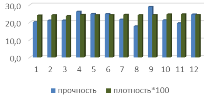
Сопоставление прочности и плотности образцов (7 сут)
